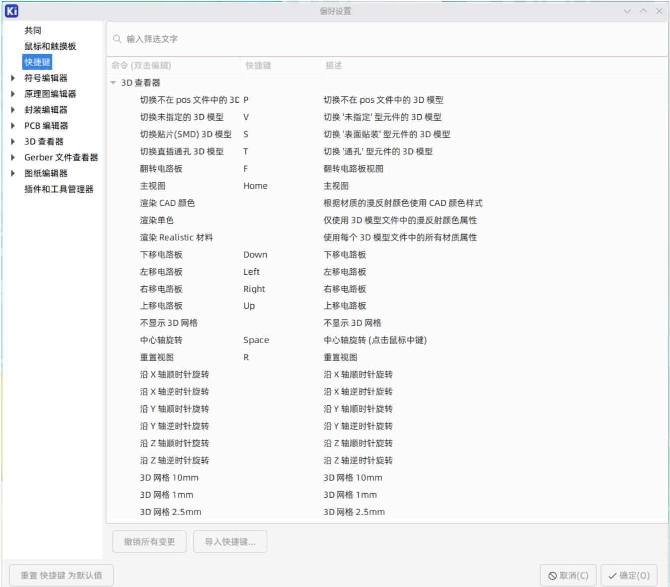
可以使用此对话框自定义用于控制 KiCad 的快捷键。公用部分中的快捷键在每个 KiCad 程序之间共享。当程序运行时，会显示每个特定 KiCad 程序的快捷键。您可以将相同的快捷键分配给不同 KiCad 程序 (例如原理图编辑器和电路板编辑器) 中的不同操作，但不能将一个快捷键分配给同一程序中的多个操作。
