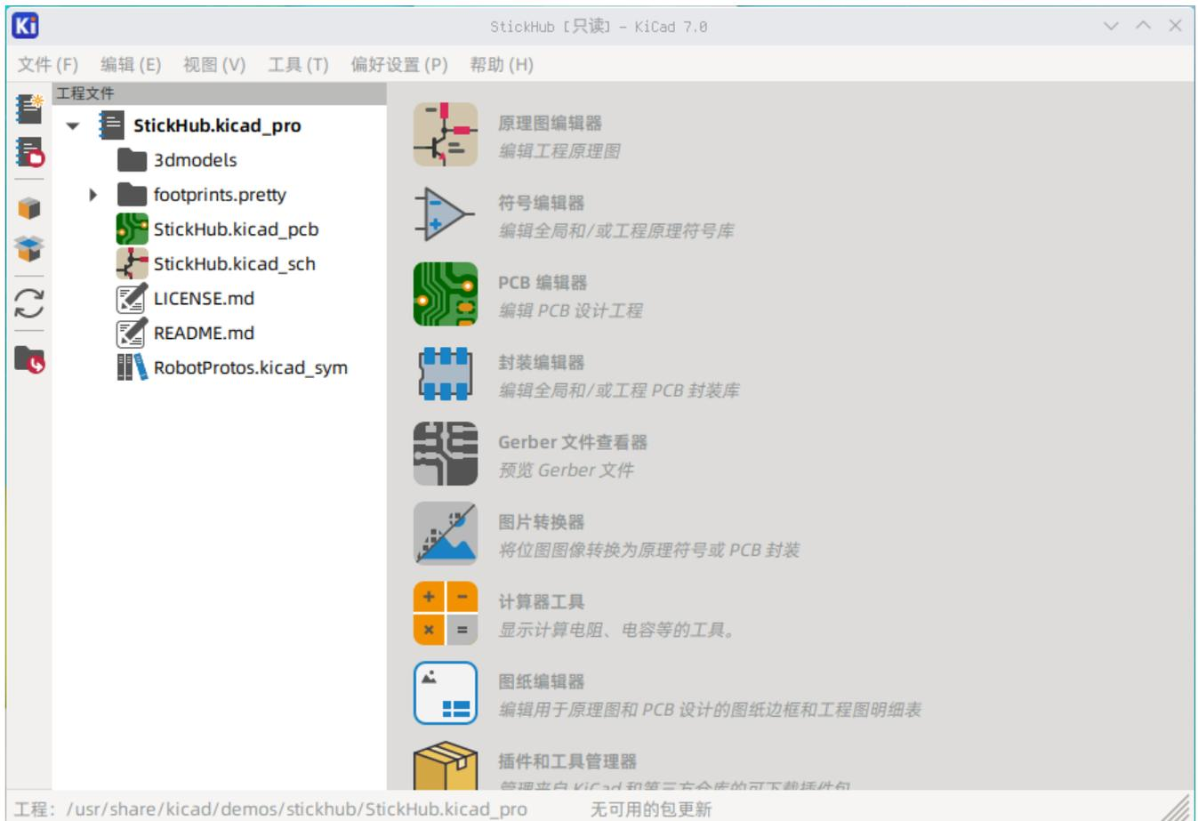
KiCad 工程管理器窗口由左侧的工作区视图和右侧的启动器组成，前者显示与打开的工程相关的文件，后者则包含各种编辑器和工具的快捷方式。
