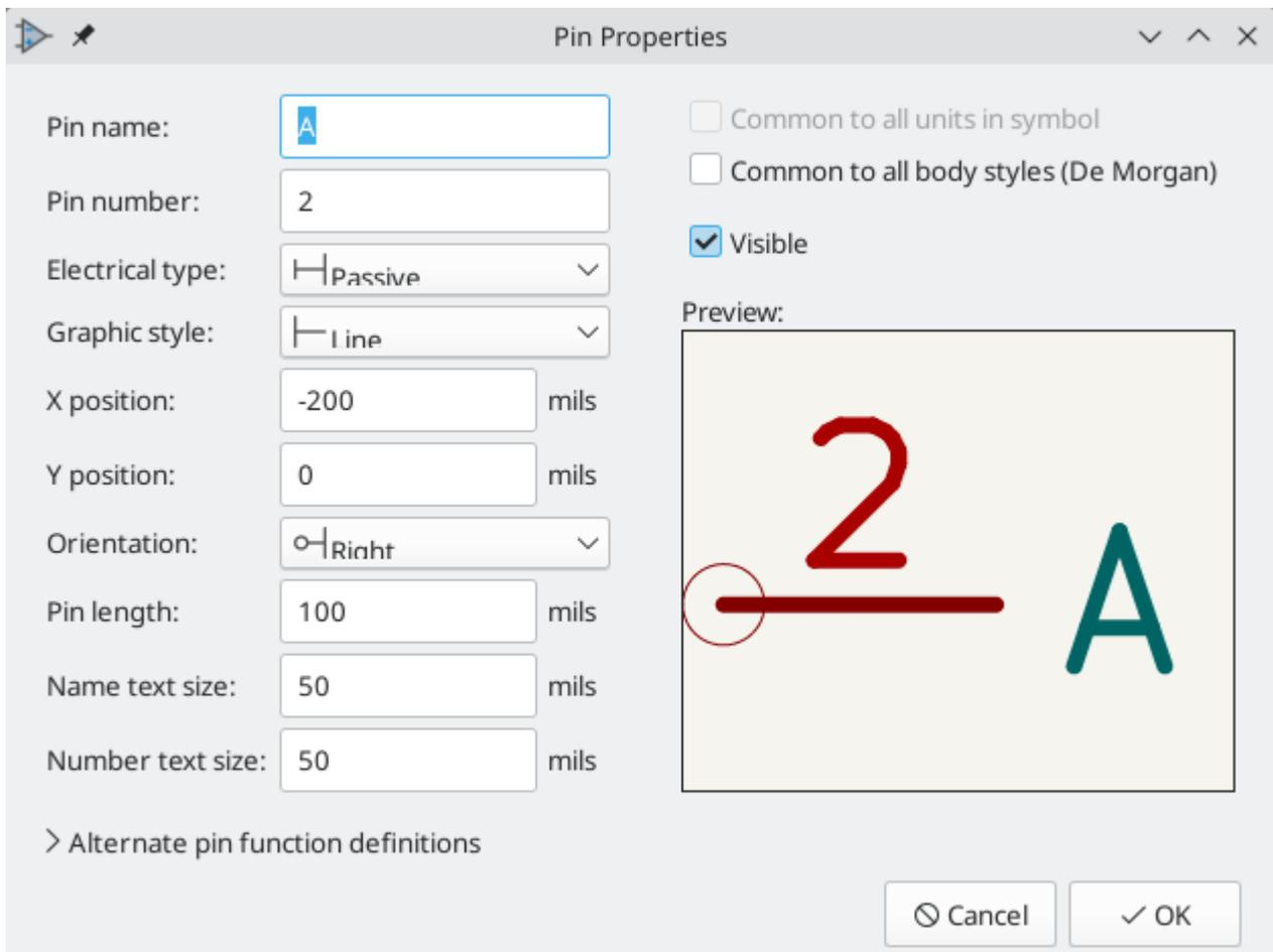
添加第二个引脚，但这次不要使用 **添加引脚** 工具。相反，按 **Insert**。一个编号为 3 的新引脚被添加到符号中，就在引脚 2 下面。
