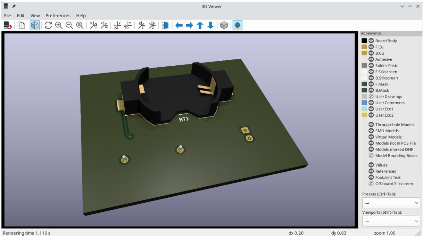
KiCad 库中的许多封装都带有 3D 模型，包括本指南中使用的所有封装。有些封装没有附带 3D 模型，《封装和 3D 模型，但用户可以添加自己的模型》。
