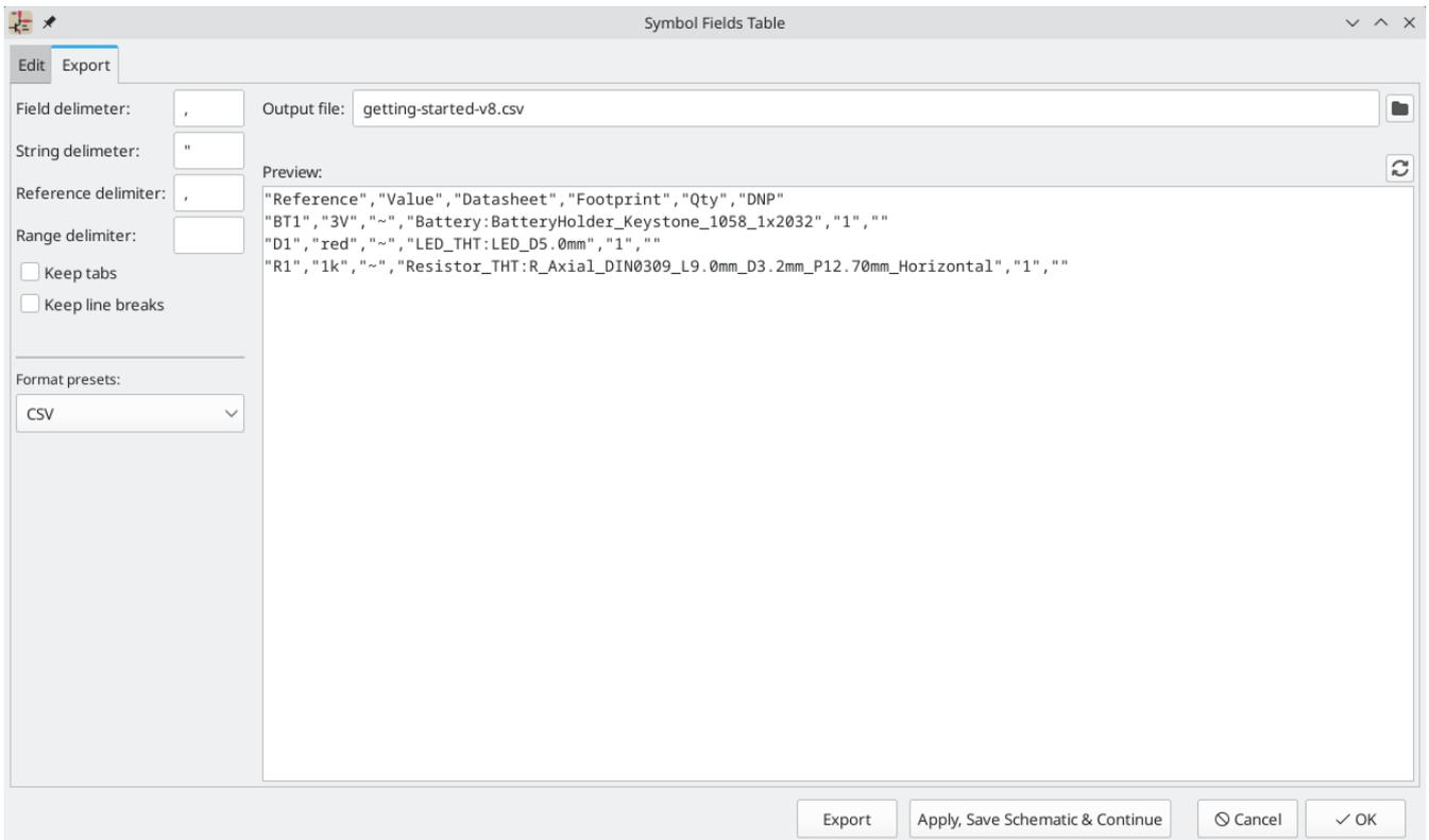
KiCad 8.0 有一个用于 BOM 导出的图形用户界面。您可以在 **编辑** 选项卡中配置哪些符号元数据将被导出，以及如何对符号进行分组，并在 **导出** 选项卡中配置输出格式。
