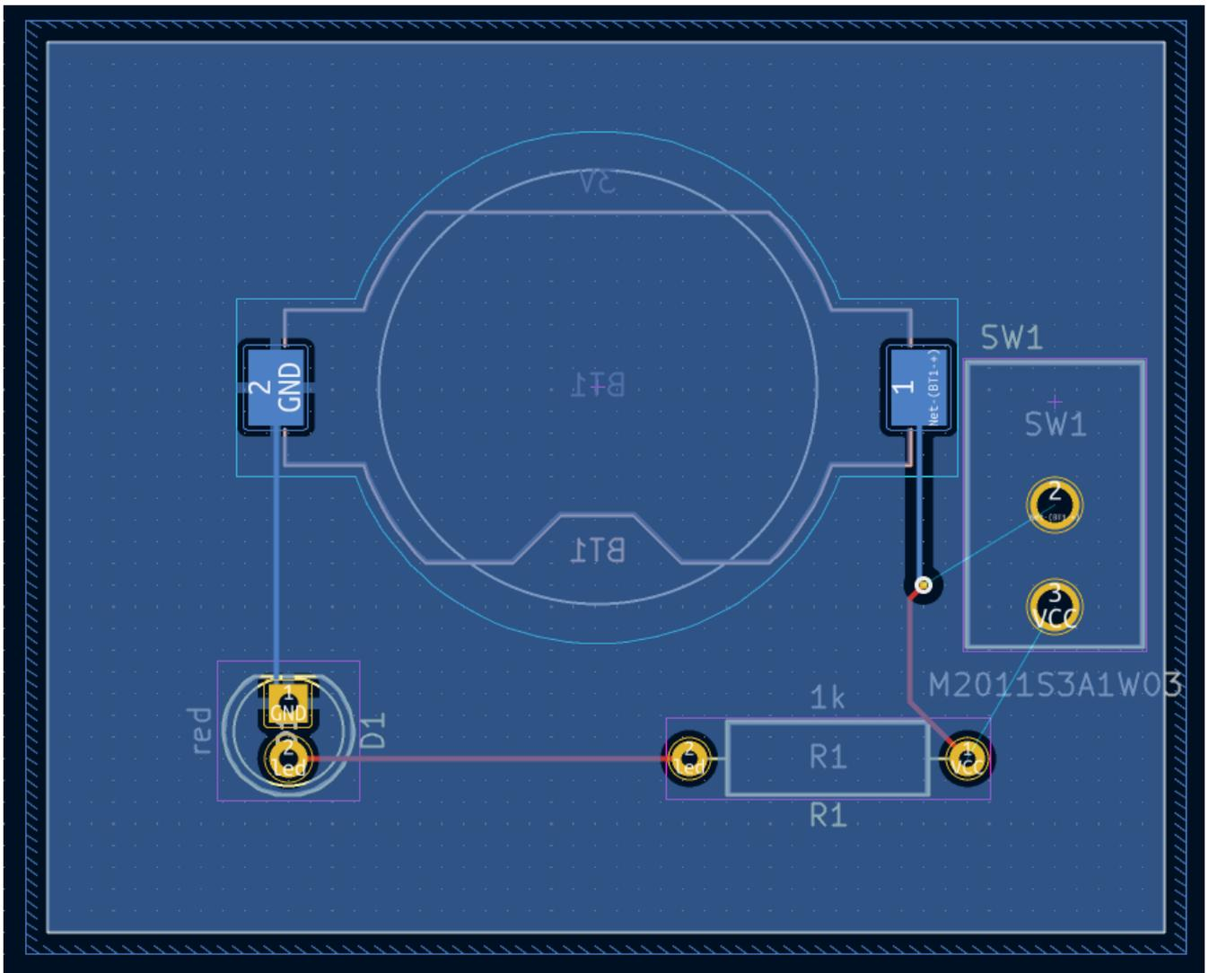
飞线显示了需要布线的新连接。此外，电池和电阻之间的连接也需要删除。
