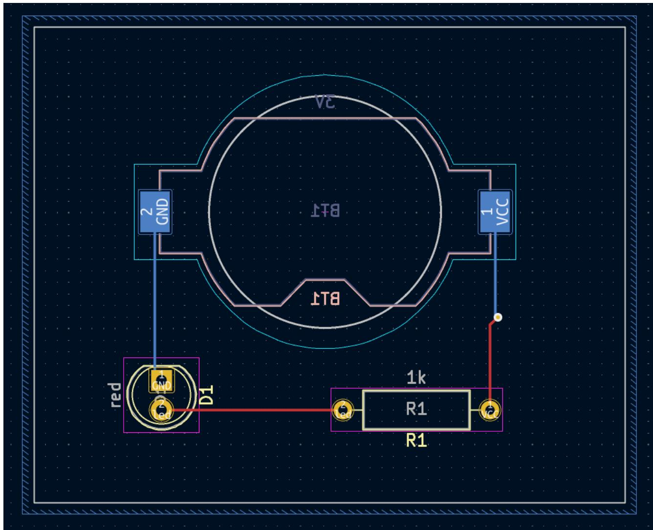
敷铜边框显示在画布上，但区还没有被填满 — 在敷铜的范围内没有铜，因此敷铜没有进行任何电气连接。用 **编辑 - 填充所有敷铜** (B) 填充该敷铜。铜已经被添加到该敷铜，但是它没有连接到 VCC 或 led 焊盘和导线，并且被板子的边缘剪掉。它与前面画的 GND 线重叠，并通过细线与 GND 焊盘连接。这些是散热条，使焊盘更容易焊接。散热条和其他敷铜设置可以在敷铜属性对话框中修改。
