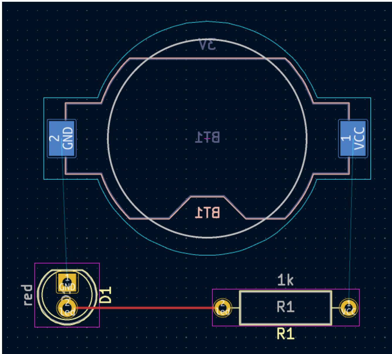
现在在 BT1 和 D1 的 GND 焊盘之间布线，从电路板背面的 BT1 焊盘开始。注意在点击 BT1 焊盘后，活动层自动变成了 B.Cu。点击 D1 焊盘来完成这个布线。
