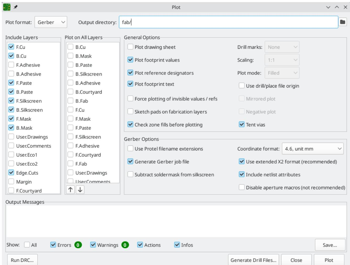
点击 **绘制** 来生成 Gerber 文件。同时点击 **生成钻孔文件...**，然后点击 **生成钻孔文件** 来创建文件，指定所有将在电路板上钻孔的位置。最后，关闭 "绘制" 对话框。设计就完成了。
