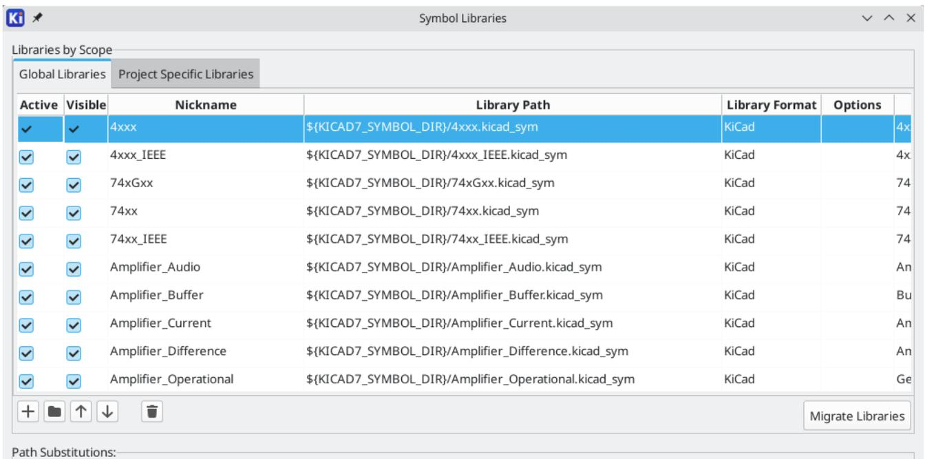
通常情况下，库的路径是通过路径替换变量定义的。这样，用户就可以在不修改库表的情况下，将所有库移动到新的位置。唯一需要更改的是重新定义变量，使其指向新位置。KiCad 的路径替换变量可通过项目管理器或任何编辑器窗口中的 **偏好设置** → **配置路径...** 进行编辑。
