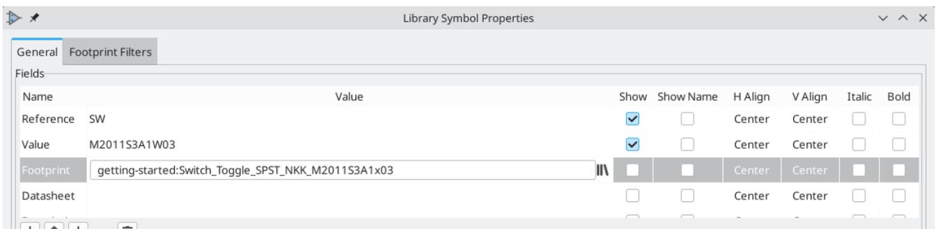
符号可以指定一个预选的封装。封装不需要手动分配给这些符号，因为在创建符号的时候就已经选择了一个封装。用户可以在封装分配过程中正常覆盖预选的封装。定义一个默认的封装对于那些通常或总是被分配相同封装的符号来说是个好主意，例如一个只在一个包中可用的元件。开关封装《默认封装，被设置为其匹配符号的默认封装》
