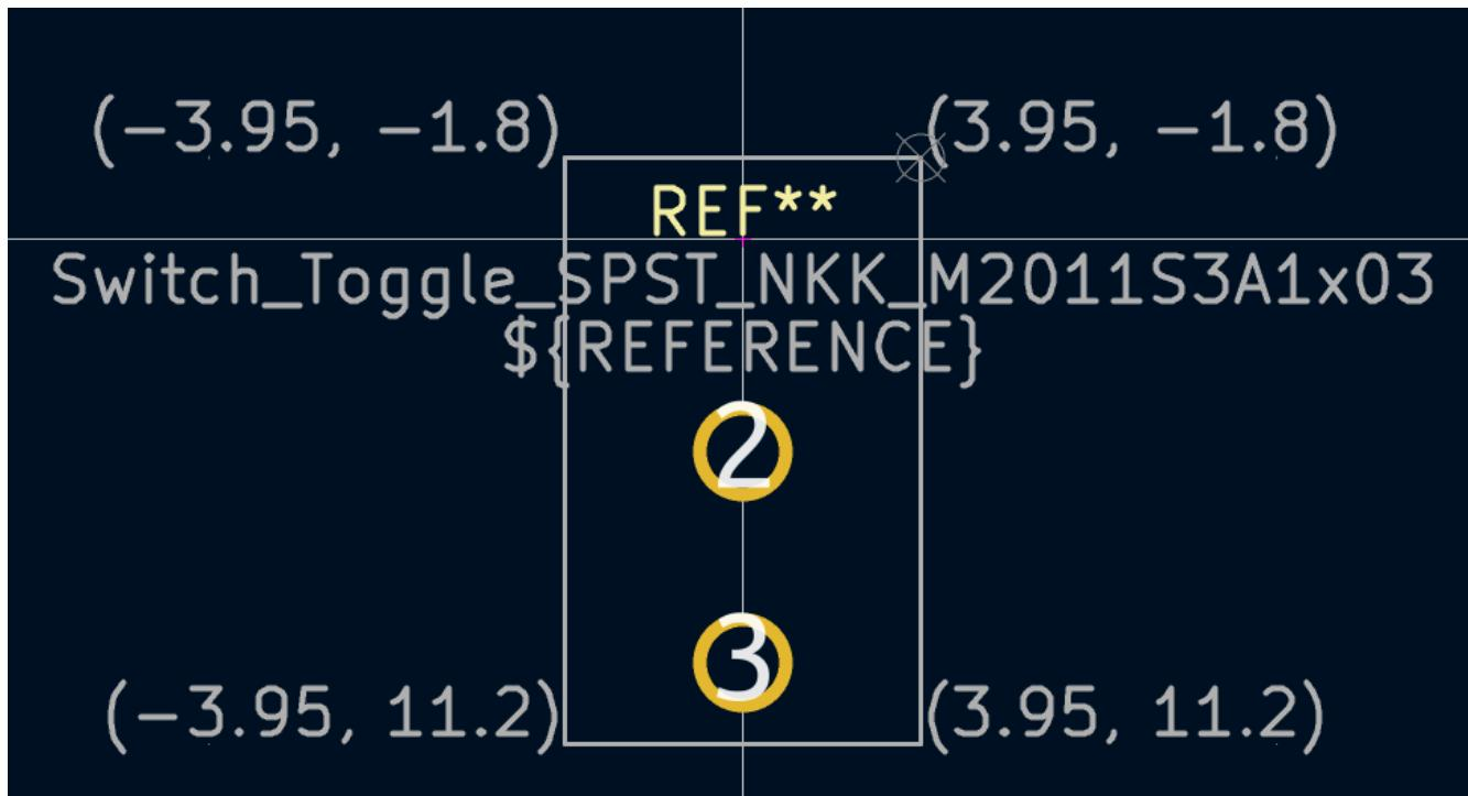
接下来，切换到 **F.Silkscreen** 层。丝网的边框应该正好在元件边框之外，所以丝网线要从制造图中向外移动 0.11 mm (0.10 mm 制造线宽度的一半，加上 0.12 mm 丝网线宽度的一半)。准确的坐标显示在下面的截图中，有用的网格设置是：
