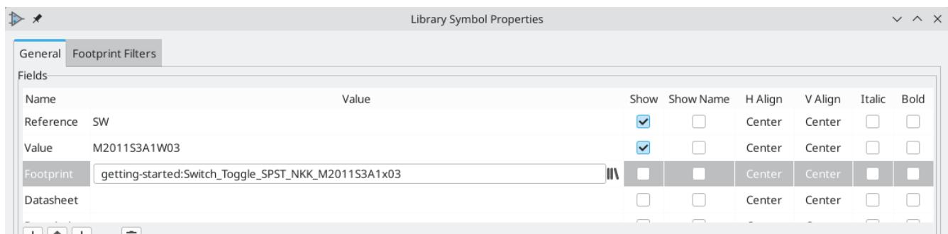
打开原理图，添加一个新符号，并选择新的开关符号。给它接线以连接或断开 LED 和电池。
