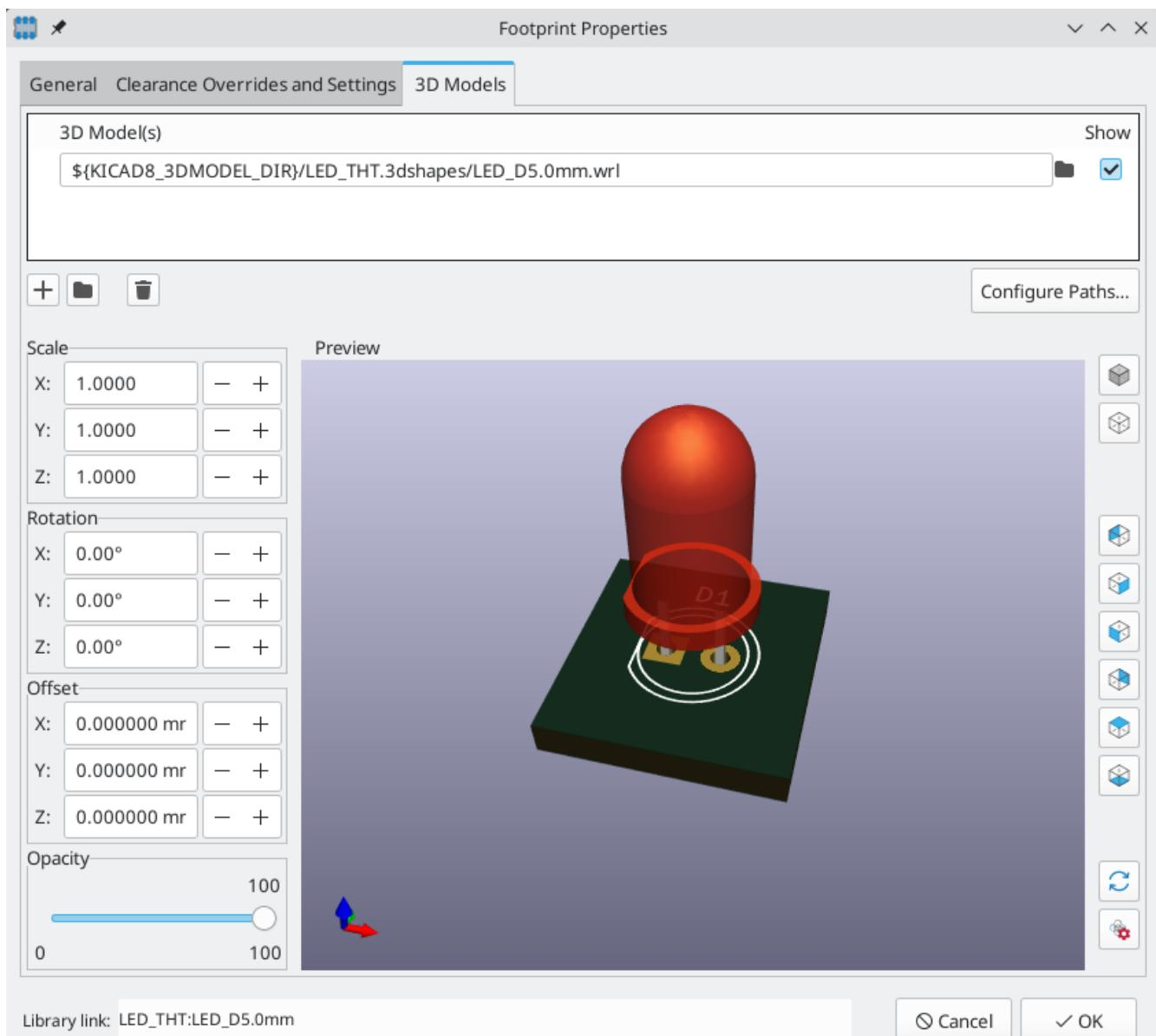
支持 STEP ( .step ) 和 VRML ( .wrl ) 两种 3D 模型格式。STEP 文件在需要尺寸精度的情况下非常有用，而 VRML 文件可以用来制作更具视觉吸引力的渲染图。KiCad 库中的许多封装都有相关的 3D 模型；这些模型都以 VRML 和 STEP 格式提供。两种模型中只有一种需要在封装中列出（通常是给出 VRML 文件名）。在为机械 CAD 目的导出电路板的 3D 模型时，KiCad 可以自动替换 STEP 版本。
