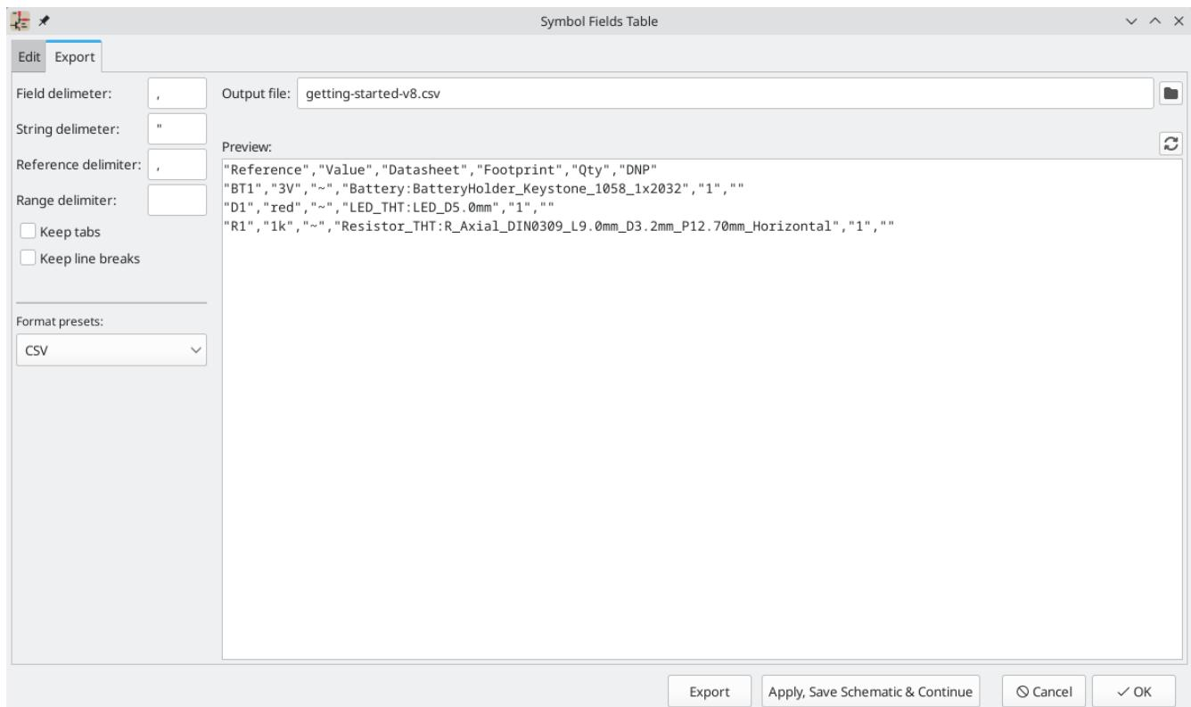
KiCad 8.0 有一个用于 BOM 导出的图形用户界面。您可以在 **编辑** 选项卡中配置哪些符号元数据将被导出，以及如何对符号进行分组，并在 **导出** 选项卡中配置输出格式。
