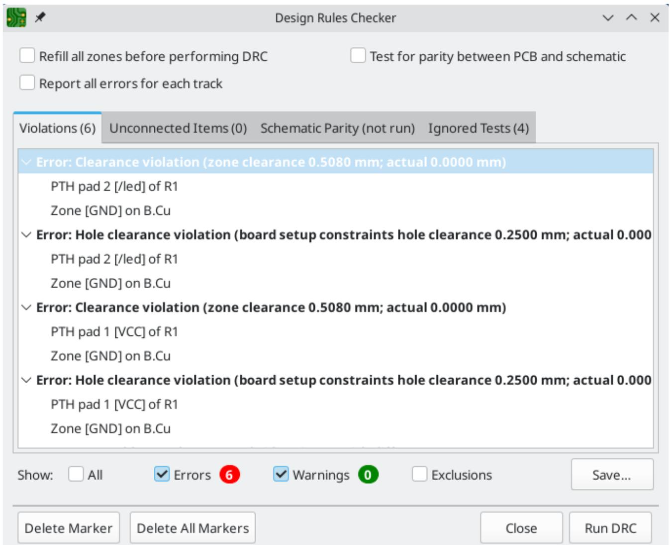
关闭 DRC 对话框，按 **B** 重新填充敷铜，并重新运行 DRC。或者，勾选 **在执行 DRC 之前重新填充所有敷铜** 复选框并重新运行 DRC。所有的违规行为都被修复。
