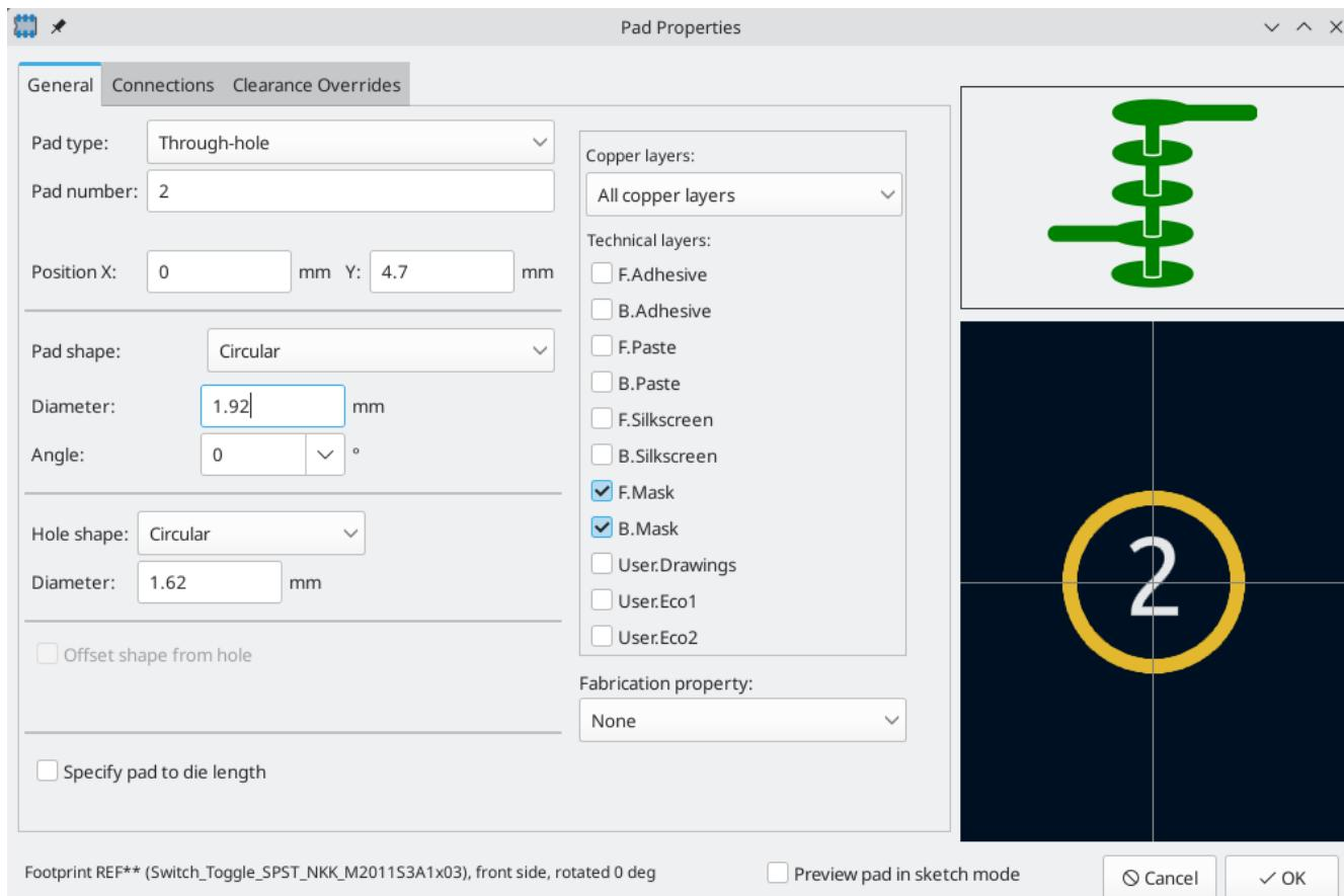
现在再次使用 **添加焊盘** 工具，将另一个焊盘放在(0, 9.4mm)处。注意，焊盘的编号会自动递增，包括焊盘尺寸和通孔的大小在内的属性会从前一个焊盘上复制下来。
