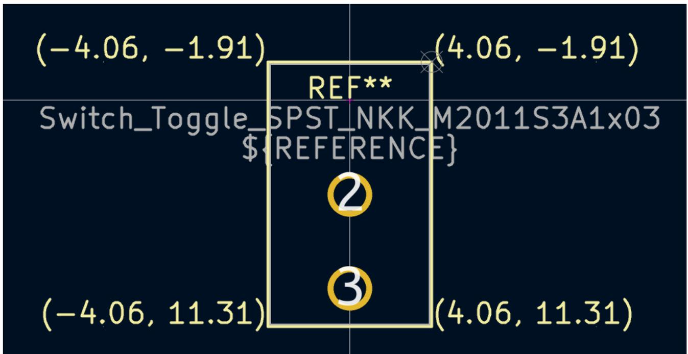
Infine, selezionare lo strato F.Courtyard. Il contorno dell'ingombro dovrebbe circondare il componente ad una distanza di 0,25 mm.
