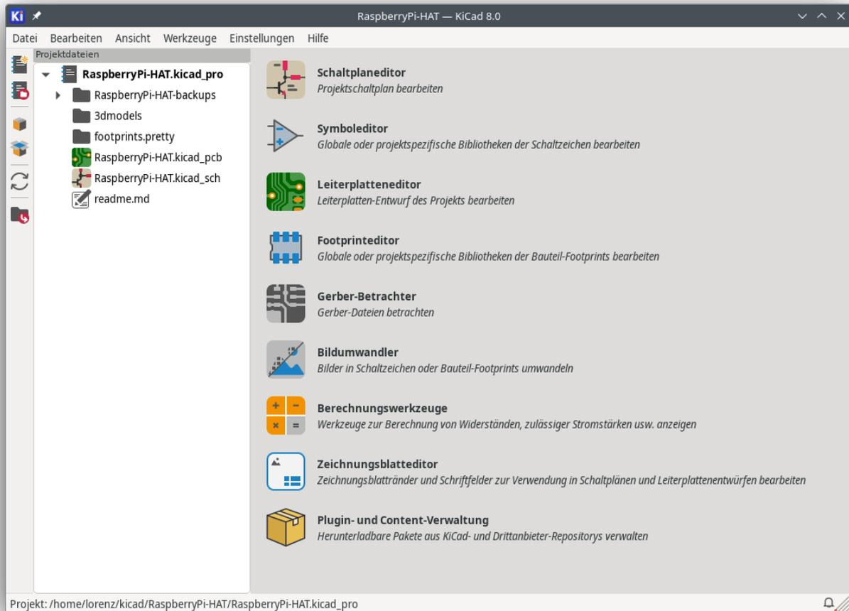
Das Fenster der KiCad-Projektverwaltung besteht aus einer Baumansicht auf der linken Seite, in der die Dateien angezeigt werden, die mit dem geöffneten Projekt verbunden sind, und einem Startmenü auf der rechten Seite, das Verknüpfungen zu den verschiedenen Editoren und Werkzeugen enthält.
