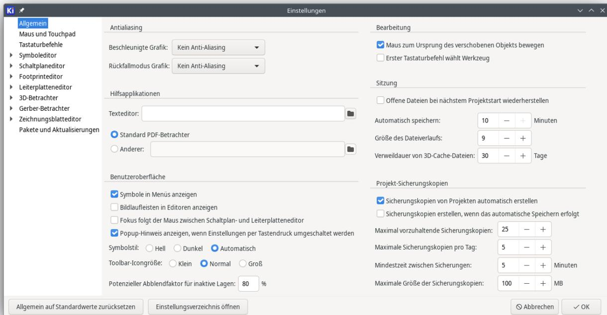
**Beschleunigte Grafik:** KiCad kann verschiedene Methoden verwenden, um Aliasing (gezackte Linien) beim Rendern mit einer Grafikkarte zu verhindern. Unterschiedliche Methoden können auf unterschiedlicher Hardware besser aussehen, daher sollten Sie experimentieren, um die Methode zu finden, die Ihnen am besten gefällt.
