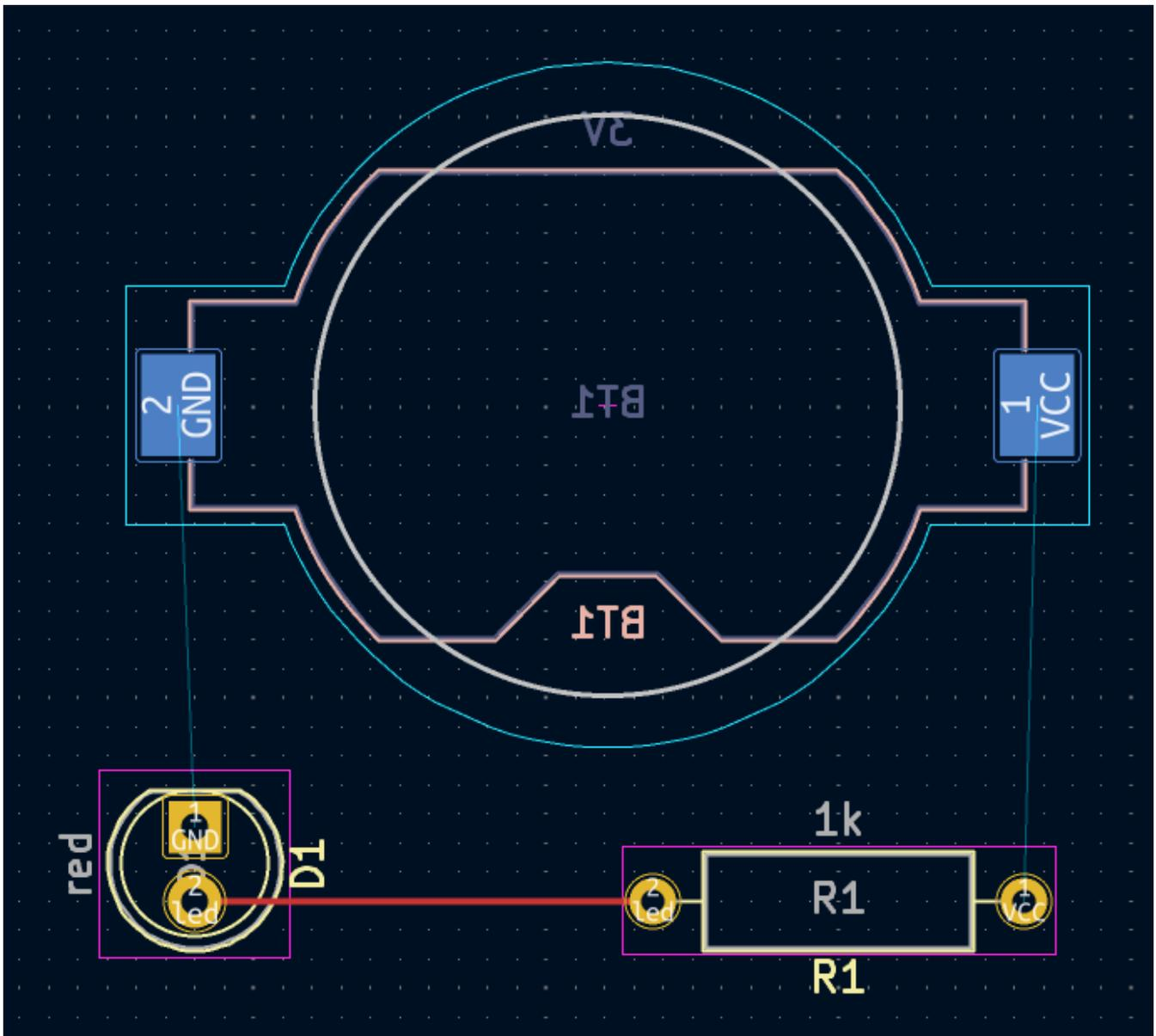
Ora tracciare una pista tra le piazzole GND di BT1 e D1, iniziando dalla piazzola BT1 sul retro della scheda. Si noti che lo strato attivo è cambiato automaticamente in B.Cu dopo aver fatto clic sulla piazzola BT1. Fare clic sulla piazzola D1 per terminare la pista.
