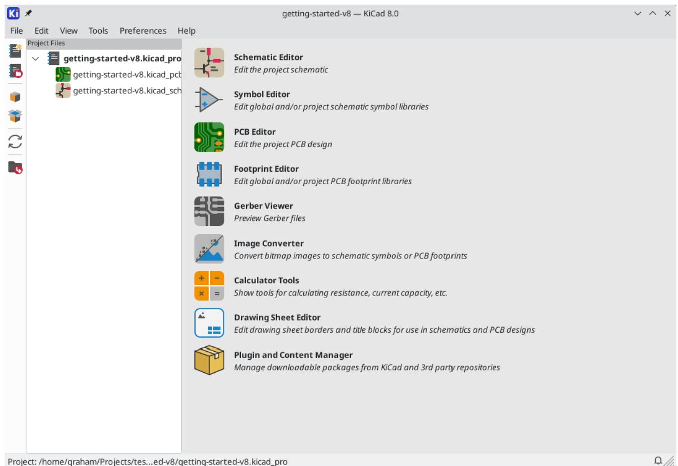
A sinistra, il riquadro **File progetto** elenca i file nel nuovo progetto. C'è un file progetto con estensione `.kicad_pro`, un file schema con estensione `.kicad_sch` e un file circuito stampato con estensione `.kicad_pcb`. Questi file condividono tutti lo stesso nome del progetto.
