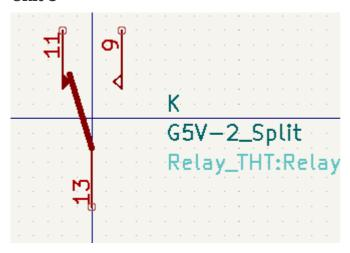
L'unità A non ha lo stesso simbolo e disposizione di pin delle unità B e C, perciò le unità non sono intercambiabili.
