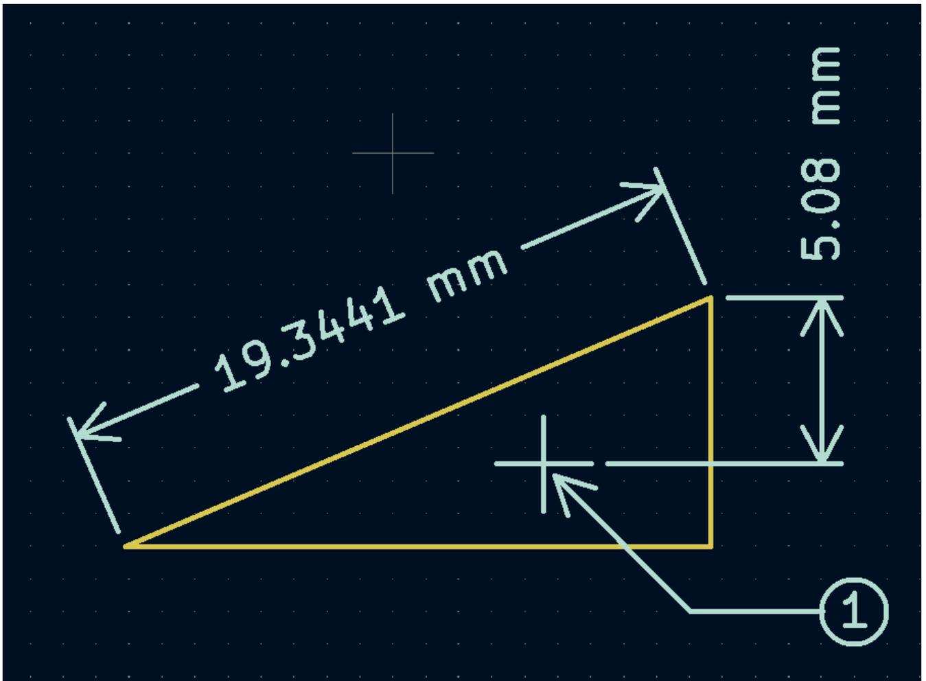
创建一个标注后，可以编辑其属性（快捷键 **E**）以改变显示数字的格式以及文本和图形线的风格。
