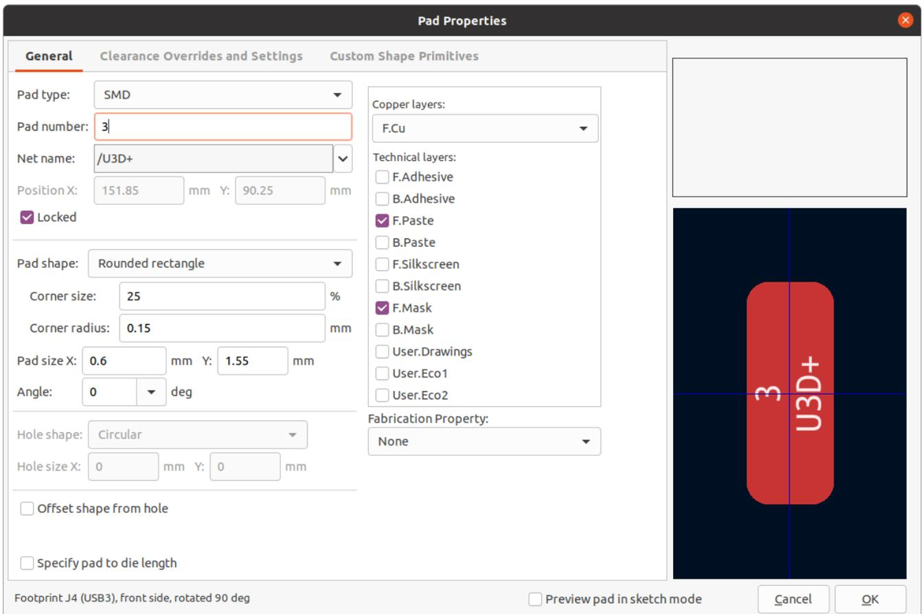
焊盘属性对话框的常规选项卡显示了焊盘的物理属性，包括它的几何、形状和层设置。
