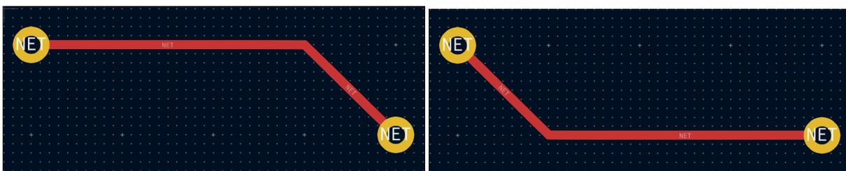
KiCad 的布线器试图根据一系列因素自动选择最佳形态。一般说来,布线器会尝试最大限度地减少路线中的拐角数量,并尽可能避免"坏"拐角(如锐角)。当从焊盘布线或布线到焊盘时,KiCad 将选择将路线与焊盘最长边缘对齐的形态。
