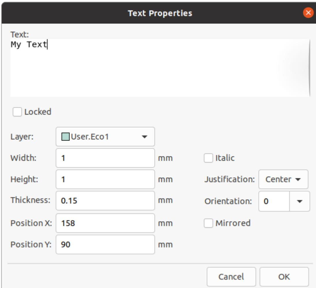
文字可以放在任何层上，但要注意，铜层上的文字不能与网络关联，不能与布线或焊盘形成连接。铜区将填充在文字对象的矩形边界框周围。
