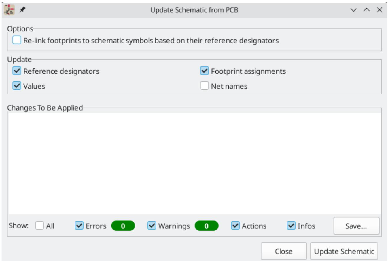
该工具将位号、值、封装分配和网络名称的变化从电路板同步到原理图。每种类型的变化都可以单独启用或禁用。
