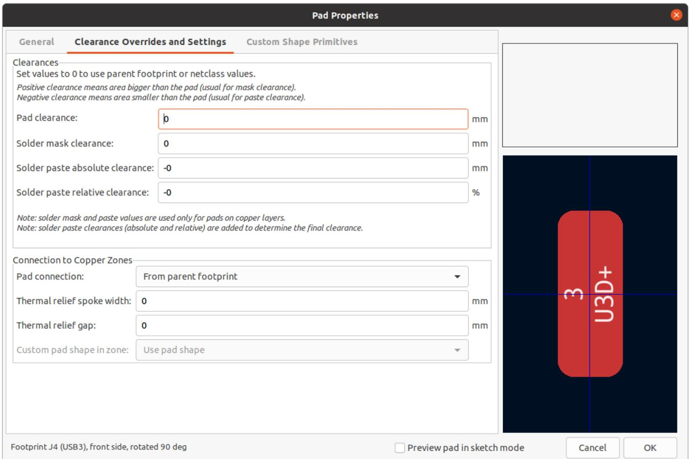
出现在任何技术层上的孔径将具有与铜层上的焊盘形状相同的形状和尺寸。在 PCB 制造过程中，制造商经常会改变掩膜和浆料孔径相对于铜焊盘尺寸的相对尺寸，但由于这种尺寸变化是特定于制造过程的，大多数制造商希望在提供设计数据时将孔径设置为与铜焊盘相同的尺寸。对于需要在设计数据中加大或缩小技术层孔径的特定情况，你可以使用 "覆盖" 标签中的设置。
