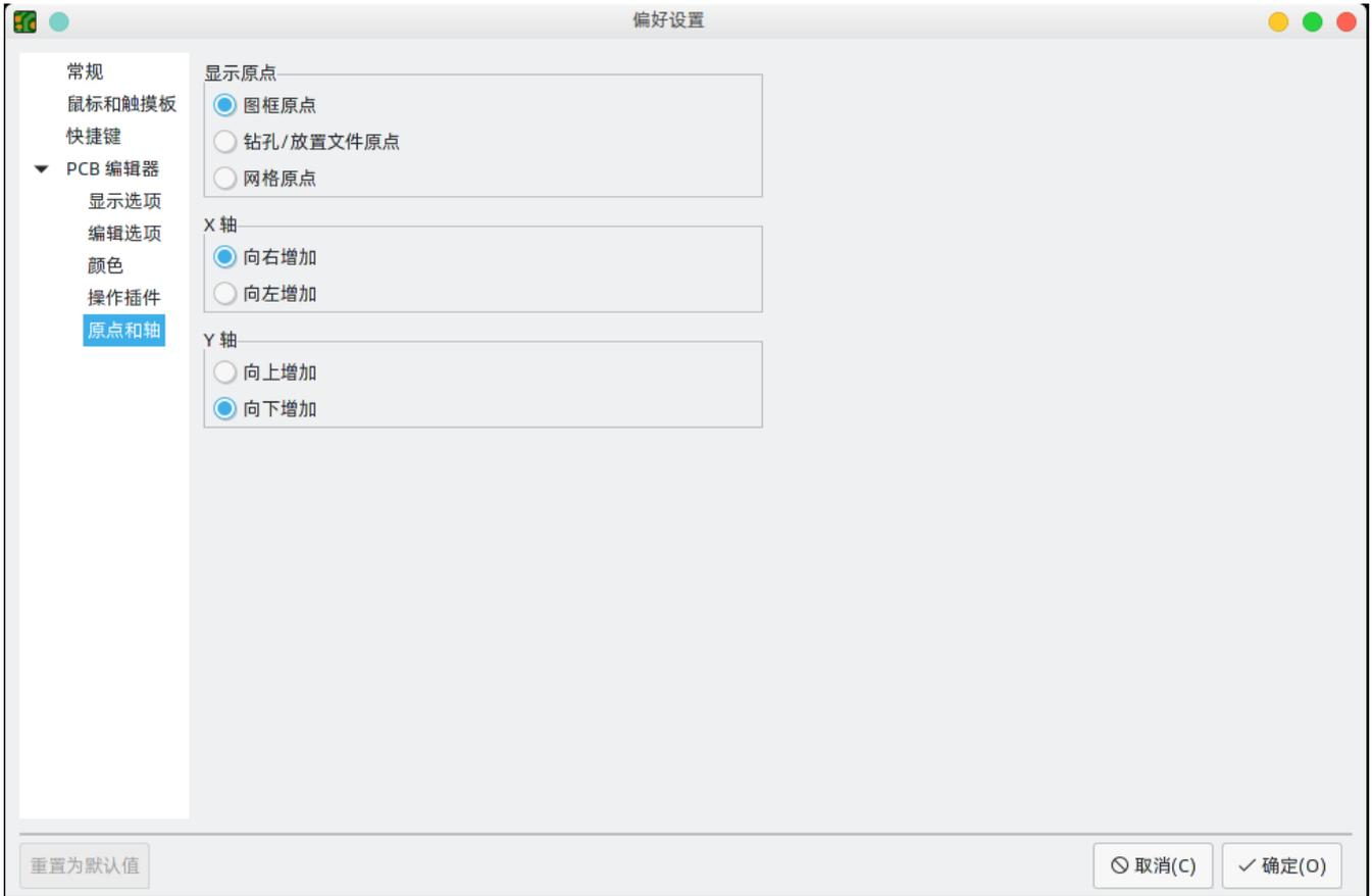
**显示原点：** 决定在编辑画布中坐标显示使用哪个坐标原点。 页面原点固定在页面的角落。 用户可以移动钻取/放置文件原点和栅格原点。
