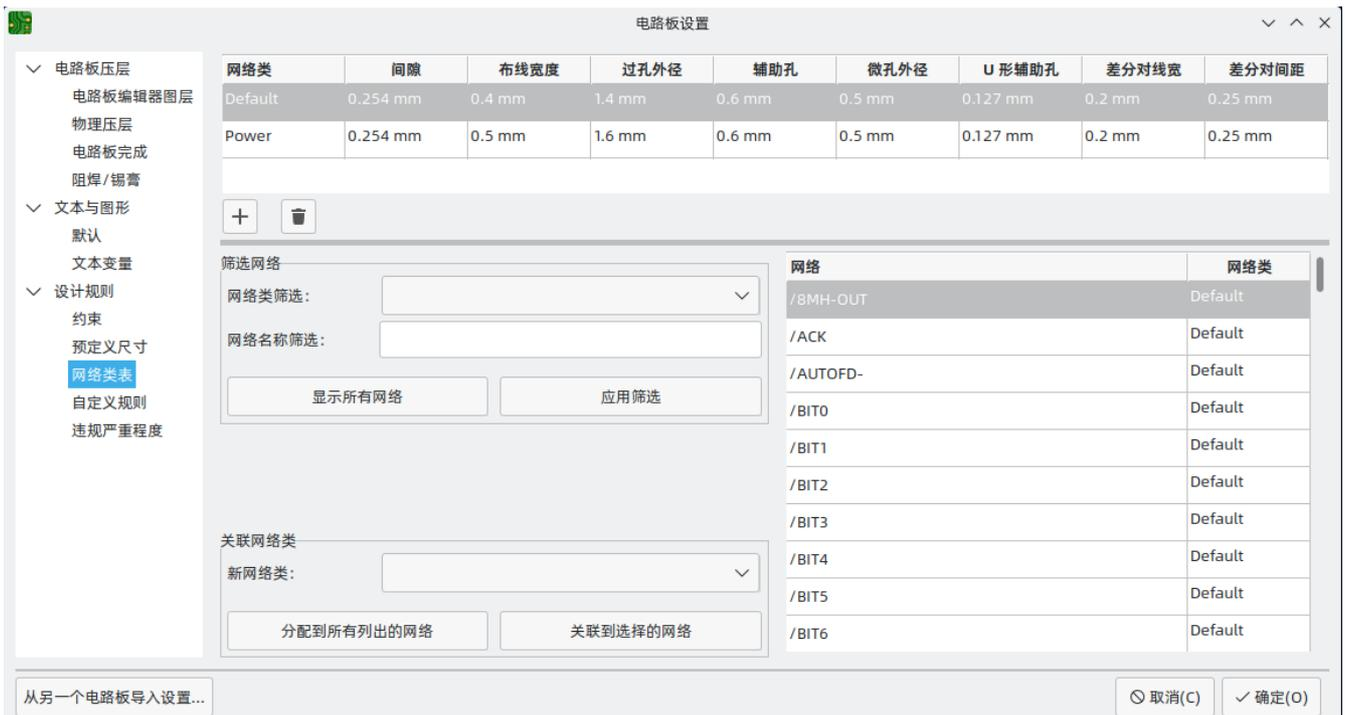
网络类部分的上部有一个表格，显示了设计中的网络类和适用于每个网络类的设计规则。每个类别都有铜的间隙、布线宽度、过孔尺寸和差分对尺寸的值。这些值将在创建布线和过孔时使用，除非有更具体的规则覆盖它们（见下面的自定义规则）。
