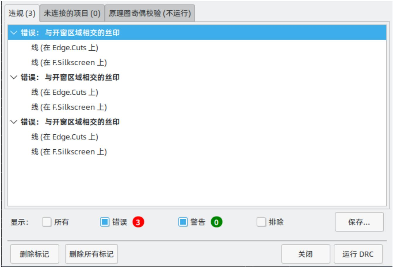
每个违规行为都涉及 PCB 上的一个或多个对象。在违规列表中，涉及的对象列在违章下面。点击列表中的违规行为将移动 PCB 编辑器的视图，使受影响的区域居中。点击违规所涉及的对象之一将高亮显示该对象。
