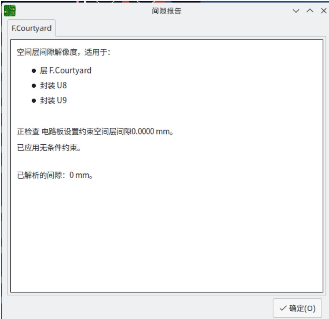
要检查适用于一个对象的设计约束，选择它并从 **检查** 菜单中选择 **约束解析**。约束报告对话框将显示适用于该对象的任何约束。
