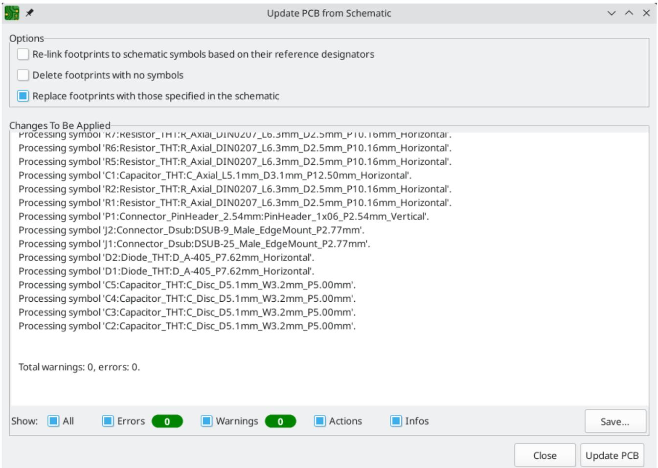
该工具将每个符号的封装添加到电路板上，并将更新的原理图信息传输到电路板上。特别是，电路板的网络连接被更新以符合原理图。
