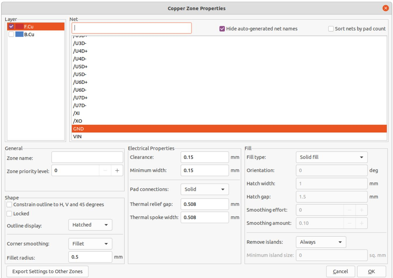
**层：** 一个区域对象可以在一个或多个铜层上创建填充铜。勾选每个铜层旁边的方框，这个区域边框应该在这些铜层上填充。每个层上的铜将被独立地填充，但所有层将共享同一个网络。
