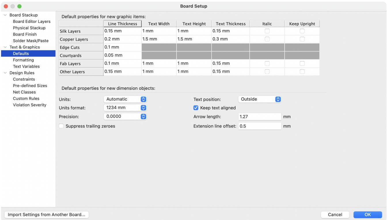
可以为对话框中显示的六种不同类别的图层配置线粗细、文字大小和文字外观。此外，可以为所有图层配置标注对象的特性。有关标注属性的更多详细信息，请参阅下面的标注部分。
