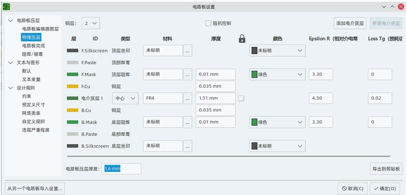
在左上角设置铜层的数量，然后根据需求输入压层的物理参数。这些参数可以保留其默认值，但请注意，在导出电路板的 3D 模型时，将使用电路板的厚度值，所以如果你打算使用这个功能，最好确保压层厚度是正确的。
