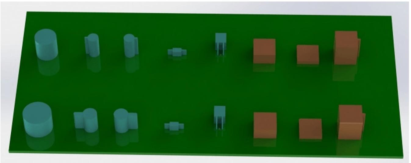
上图显示了由程序 `idfcyl` 和 `idfrect` 生成并在一个机械 CAD 程序中渲染的样本边框。从左到右分别是 (a) 垂直径向引线圆柱体，(b) 垂直轴向引线圆柱体，左边有金属丝，(c) 垂直轴向引线圆柱体，右边有金属丝，(d) 水平轴向引线圆柱体，(e) 水平径向引线圆柱体，(f) 方形边框，普通，(g) 方形边框有倒角，(h) 方形边框有轴向引线在右边。上面的边框以毫米为单位，下面的边框以英寸为单位。
