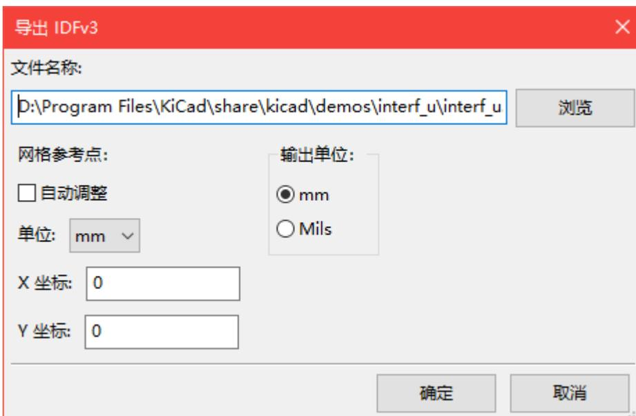
**网格参考点：**选择导出的模型参考点的位置。如果选择了 **自动调整** 选项，KiCad 将把参考点设置为 PCB 的中心点。否则，参考点将相对于显示原点设置。
