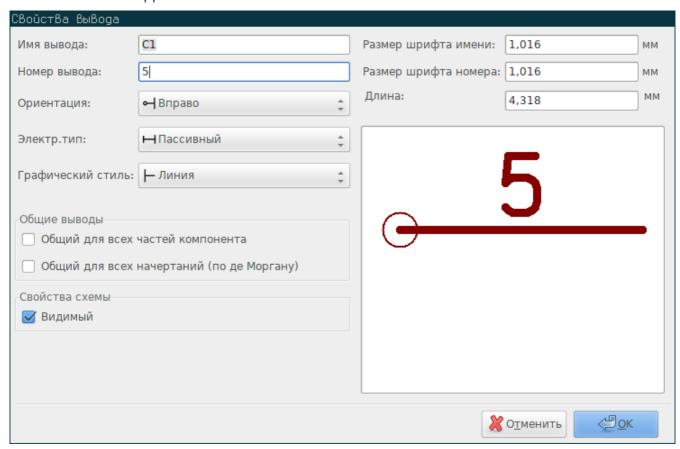
Диалог свойств вывода позволяет редактировать все его параметры. Этот диалог автоматически отображается при создании вывода или при двойном щелчке на существующем выводе. Данный диалог позволяет изменять:
