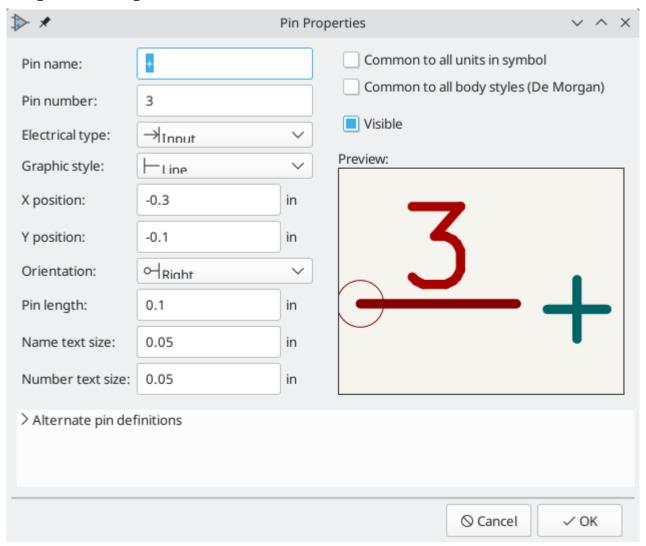
La fenêtre des propriétés des pins vous permet de modifier toutes les caractéristiques d'une pin. Cette fenêtre apparaît automatiquement à la création de la pin ou quand vous double-cliquez sur une pin existante. Vous pouvez modifier :
