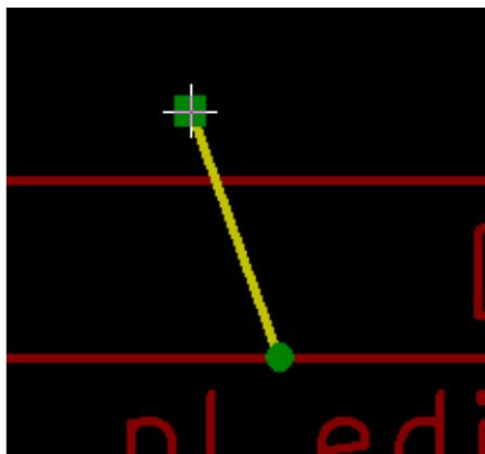
Wenn das Element ausgewählt worden ist, oder einer deren Endpunkte, kann es durch Mausbewegungen verschoben und durch einen Linksklick platziert werden.
